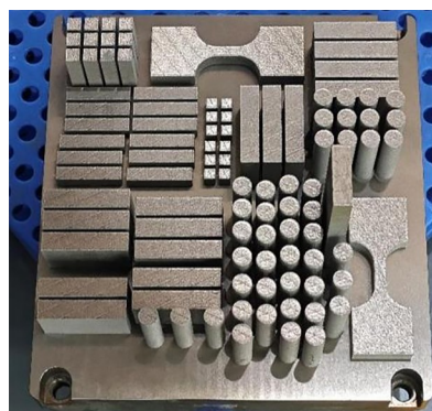
图6 增材制造完成的热处理用试样
